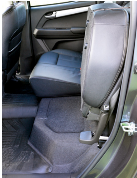
Mehr Platz: Die hinteren Sitzflächen kann man einzeln hochklappen. Sie werden mit einem Haken an der Kopfstütze befestigt.
