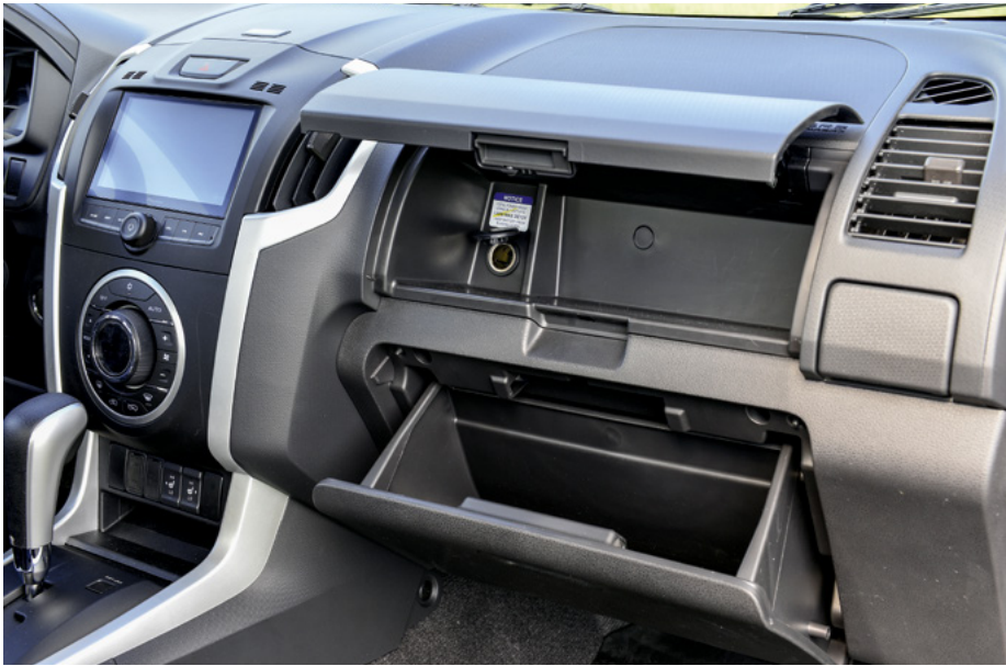
Doppelt: Der D-Max bietet vorne zwei separate Handschuhfächer. Im oberen Fach findet sich eine 12-Volt-Steckdose. Dafür gibt es keinen Zigarettenanzünder.
