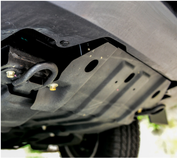
Durchdach: Vorne gibt es zwei Abschleppösen. Sie sind rechts und links vom serienmäßigen Unterfahrschutz montiert.
