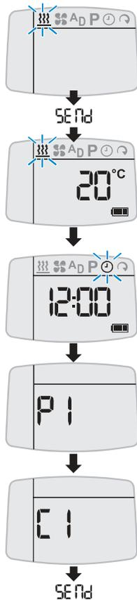
Wurde der Menüpunkt C1 / 07 mit **OK** bestätigt, werden die Daten übertragen. Anschließend wird die Uhrzeit angezeigt.
