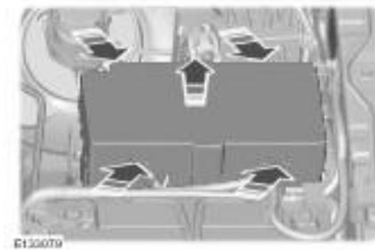
Verriegelungen lösen und Abdeckung ausbauen.
