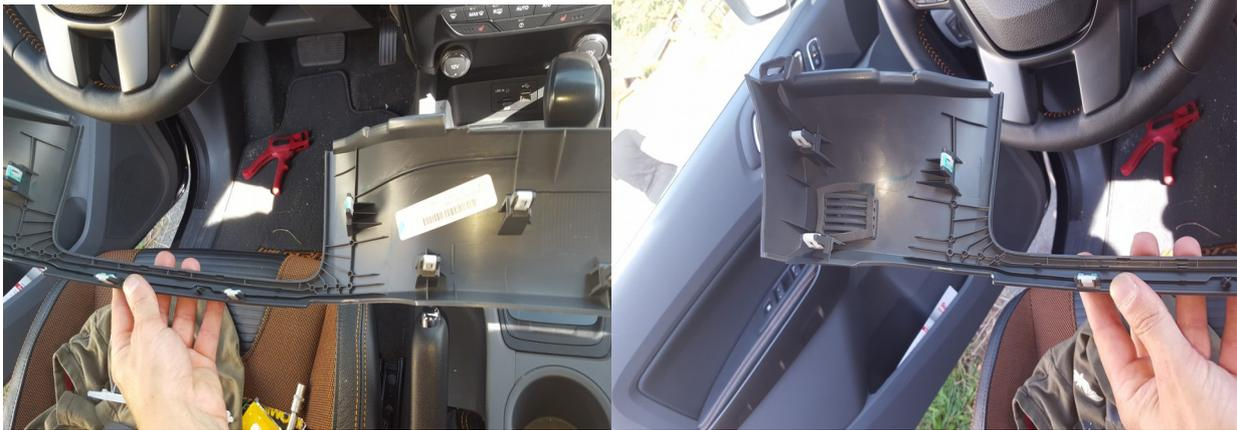
6. Jetzt müsst ihr die Steckdosen unten ausbauen. Dazu jeweils Links und Rechts eine schraube herausdrehen. Nachdem Ihr die Einheit etwas herausgezogen habt seht ihr dahinter die Kabel für die Steckdosen. Diese ausstecken indem dir Verriegelung oben etwas hineingedrückt wird. Danach kann das Teil mit etwas Fummeln herausgenommen werden. Bilder:
