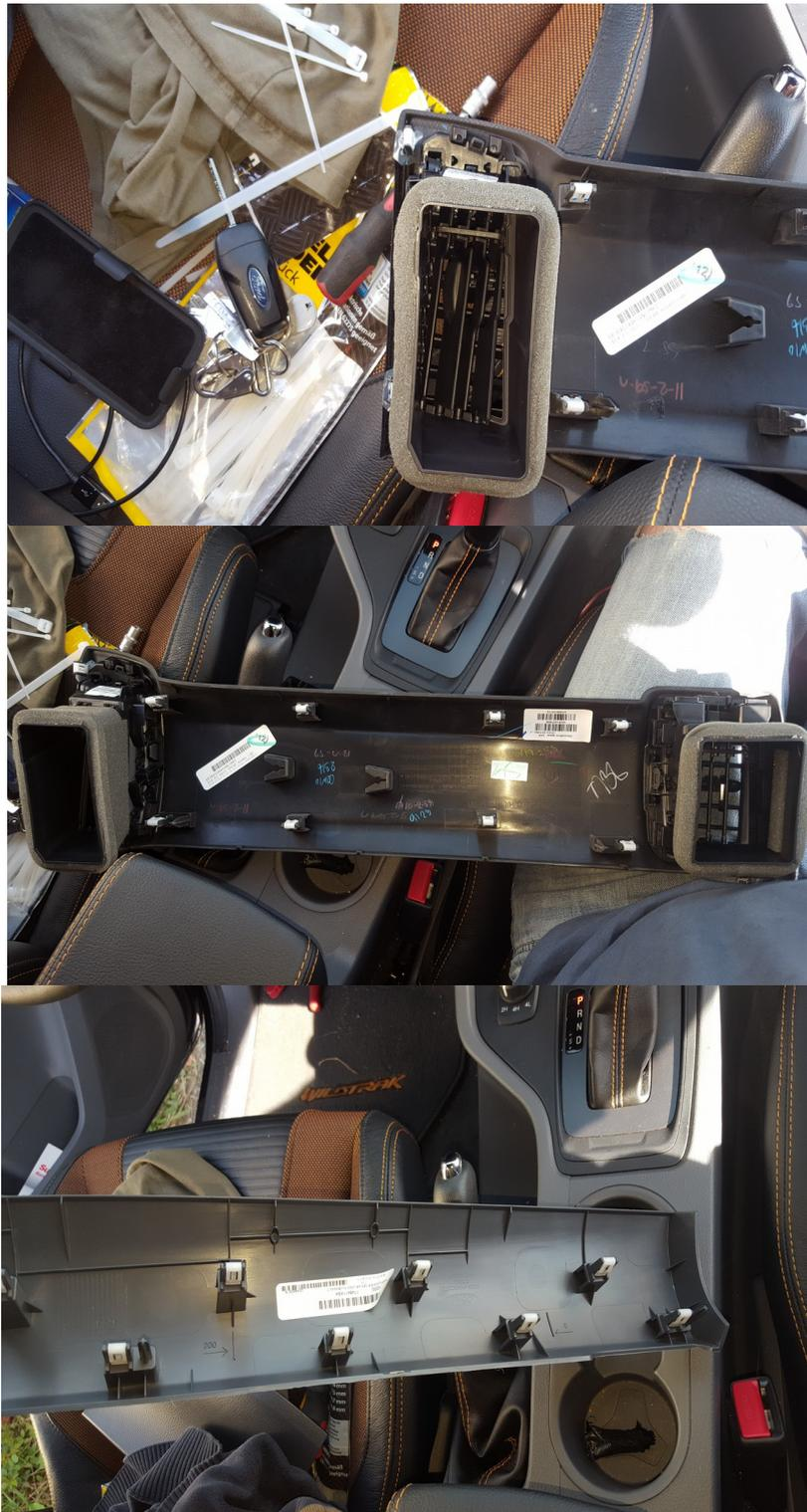
5. Kunststoffblende unterhalb Bildschirm entfernen (diese reicht vom Fahrer bis zum Beifahrer rüber. Hier ebenfalls wieder durch dahintergreifen und vorsichtiges daran ziehen die clipse aushaken. Aufpassen dass Ihr die Blende nicht knickt!
