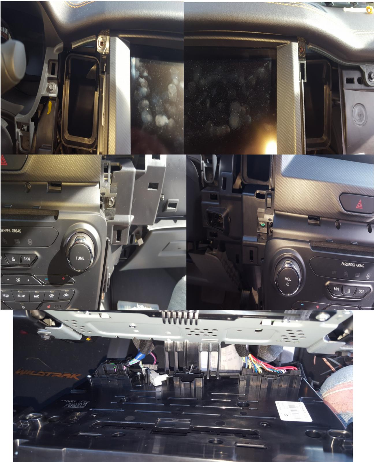
8. Danach seht ihr Oben den Bildschirm und li / re davon die Schrauben. Diesen habe ich nicht entfernt. Darunter befindet sich die Radioeinheit. li / re davon die Schrauben entfernen und nach vorne herausziehen. Bilder:
