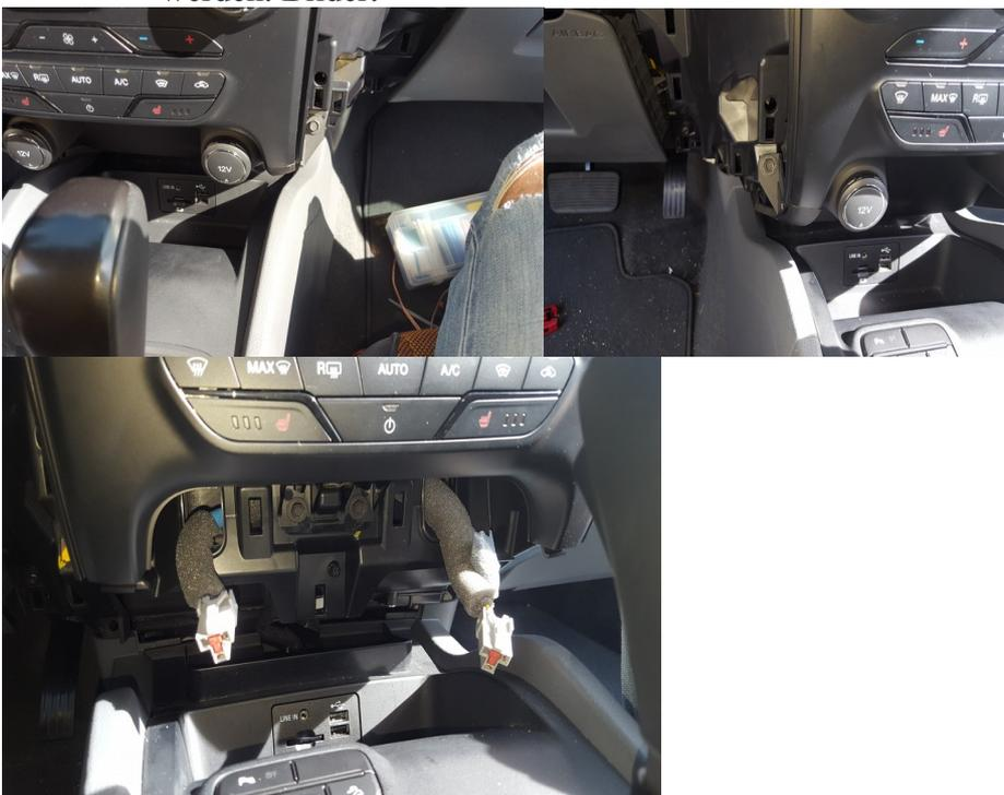
7. Jetzt die beiden Schrauben in der Mitte unten, und an den Seiten entfernen. Dann könnt Ihr das Bedienteil inkl Bildschirmblende entfernen. Beim rausnehmen bitte oben das Amateurbrett etwas hochdrücken da mittig ein kleiner Kunststoffstift ist. Geht aber Problemlos. Danach die Stecker hinten abziehen und zur Seite legen. Bilder sagen mehr als Worte:
