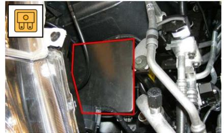
4. Dargestellte Sicherung im Kastendeckel entfernen.
