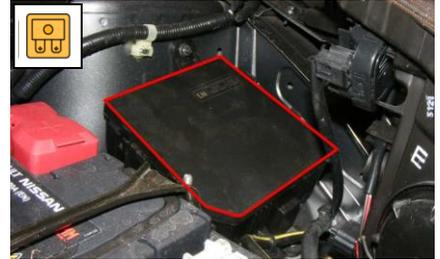
2. Dargestellte Sicherungen im Kastendeckel entfernen.
